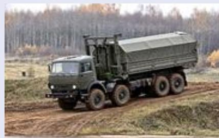
**KAMAZ - 6350** бортовой тягач. Унифицированный армейский полноприводный автомобиль многоцелевого назначения семейства «Мустанг». На платформе тягача монтируется ЗРК Панцирь-С1.
