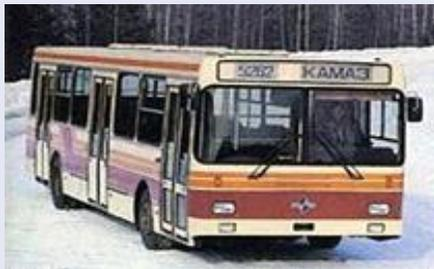
**KAMAZ - 5262** опытный высокопольный автобус большого класса производства Камского автомобильного завода. Был выпущен в 1993 году в единственном экземпляре. Данный проект стал первой попыткой автозавода создать автобус на собственном шасси.
