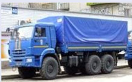
**КАМАЗ - 43118** грузовой автомобиль повышенной проходимости с бортовой платформой.
