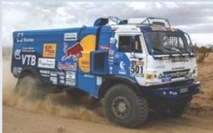
**KAMAZ - 43509** спортивный грузовой автомобиль высокой проходимости, разработанный и построенный раллийной командой «КАМАЗ-мастер» как автомобиль сопровождения (так называемая «техничка»).
